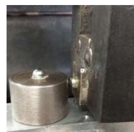
Figura 13 - Componente para aplicação pontual das forças (CAPF)
