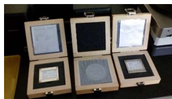
Figura 19 - Padrões de Calibração do Rugosímetro (esquerda para a direita): PGN-3; PEN-10 e PGN-10
