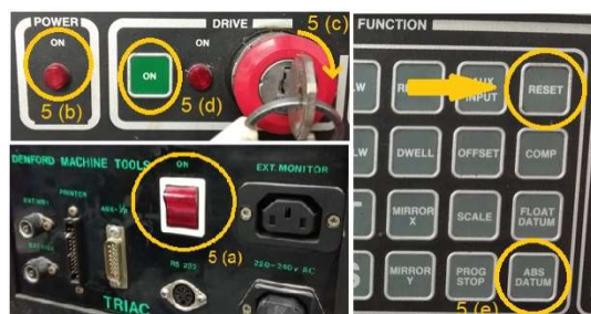
Figura 2 - Preparação da Cadeia Cinemática: Face Posterior do Aparato (Figura Inferior Esquerda); Pormenores do Painel Controlo da Cadeia Cinemática (Figuras Direita e Superior Esquerda)
