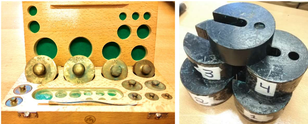
Figura A.III.1 - Massas Calibradas: (a) Estojo com Massas de 200, 100 e 50 gramas; (b) de 4500 (1, 2, 3, 4) e 3135 gramas (no topo)
