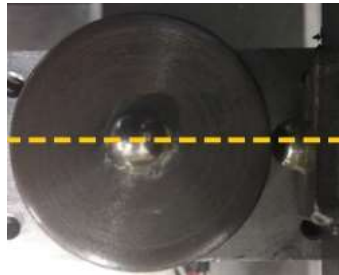
Figura 5.1 - Alinhamento Batente /Esfera
